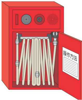
屋内消火栓設備
